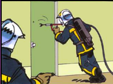
2) Le mélange eau haute pression / substance abrasive attaque la porte.
