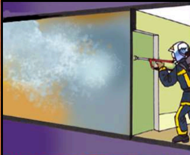
5) Au débit de 50 à 60 l/min, la température va passer de 750 à 100° en 1 minute!
